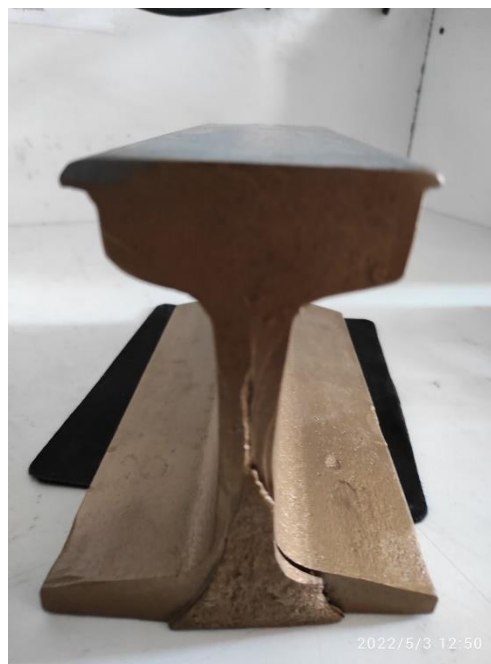
Рис. 3.3 Деформація головки рейки
