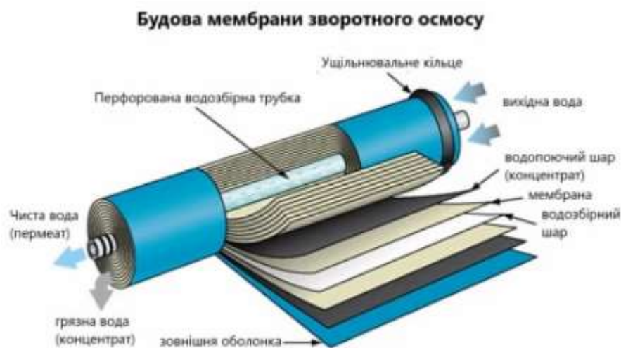
Рисунок 3.1 – Конструкція мембрани зворотного осмосу
