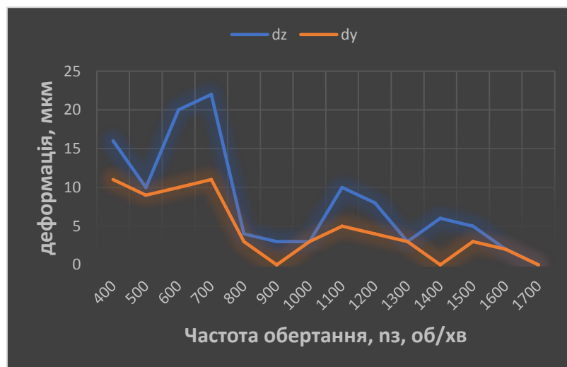
Рис.1.11. Графіки залежностей амплітуд автоколивань за осями Z і Y від частоти обертання заготовки
