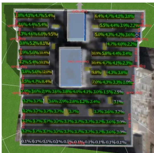
Рисунок 3.26 – Аналіз затінення залишених модулів
