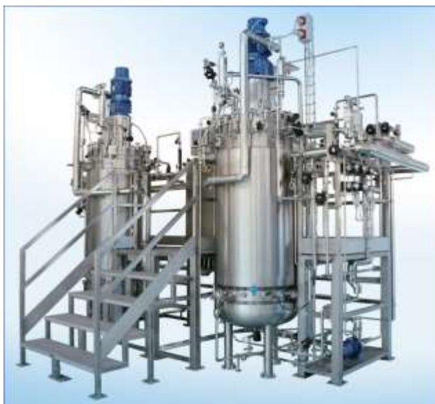
Рис. 11.2. Культивування мікроорганізмів в ферментерах
