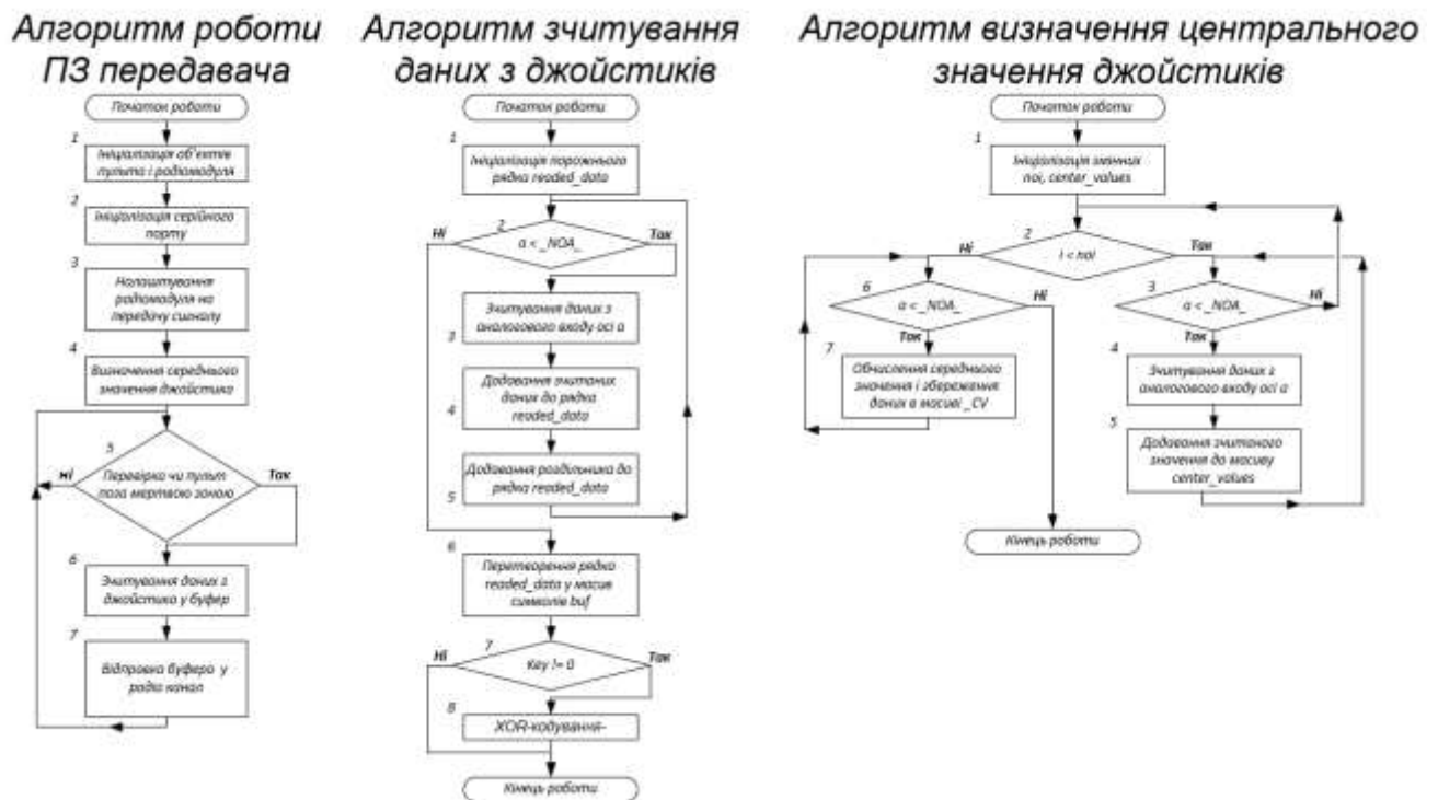
Рисунок 19 – Блоксхеми основних алгоритмів передавача
