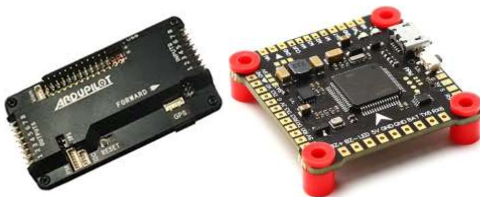
Рисунок 7, 8 – ПКР «Ardupilot» зліва, та «Betaflight» справа
