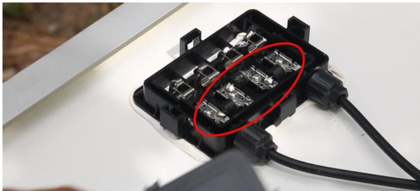
Рисунок 3.3 - Байпасні діоди в розподільній коробці фотомодуля [49]
