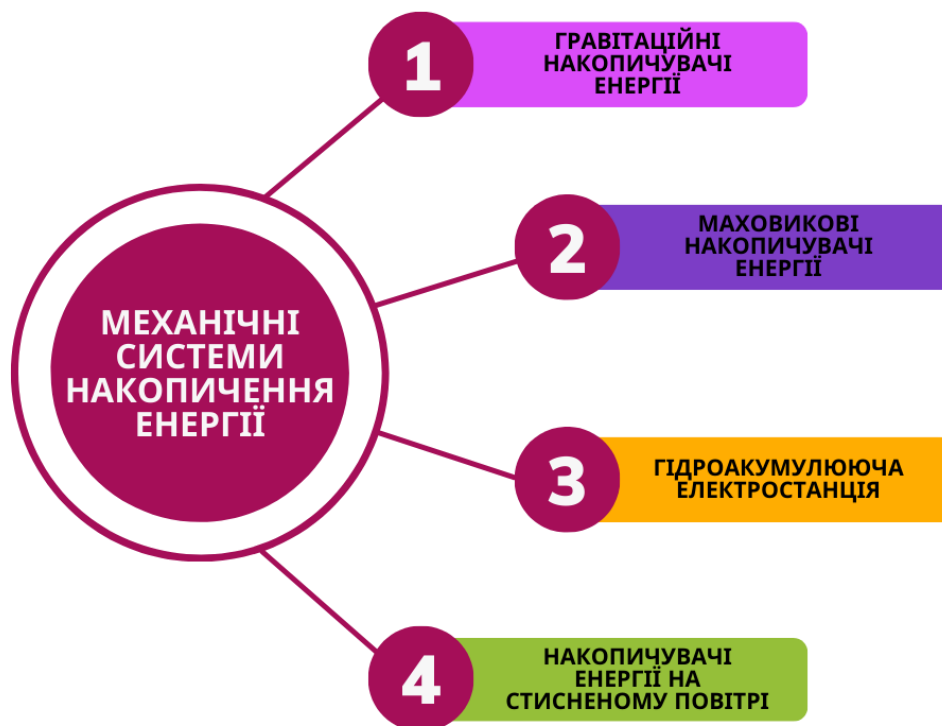
Рисунок 1.1 – Класифікація механічних систем накопичення енергії
