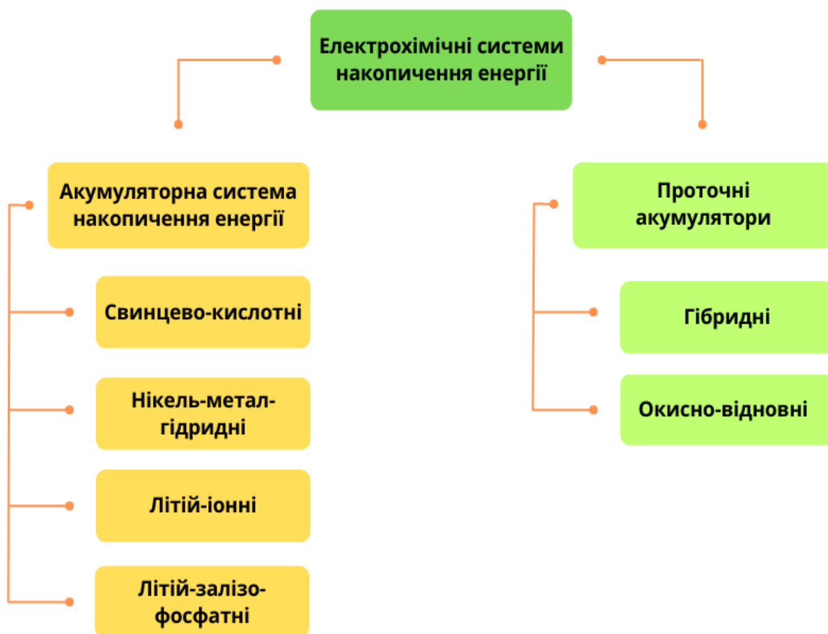
Рисунок 1.10 – Структура електрохімічної системи накопичення енергії
