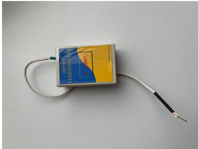
Рисунок 2.3 – Аналоговий датчик температури з роз'ємом MiniDIN
