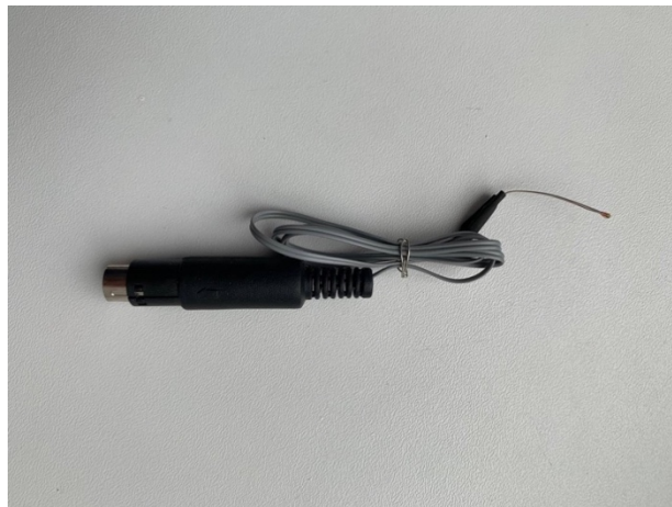
Рисунок 2.2 – Цифровий датчик температури з роз'ємом MiniDIN
