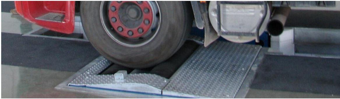
Рис. 1.16. Зображення функціонуючого стенду EUSAMA [2]
