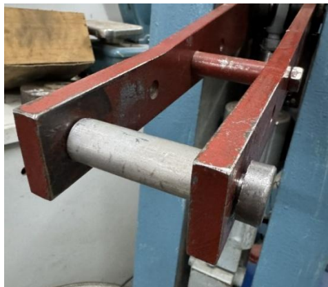
Рис. 3.10. Приклад верхнього кріплення на стенді
