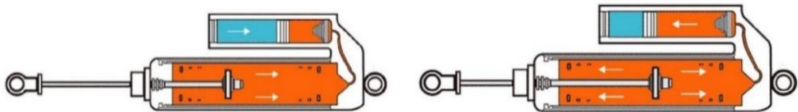
Рис. 1.11. Приклад роботи регульованого амортизатора з виносним резервуаром [7]
