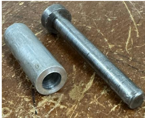
Рис. 3.9. Фіксатор амортизатора що використовується у стенді
