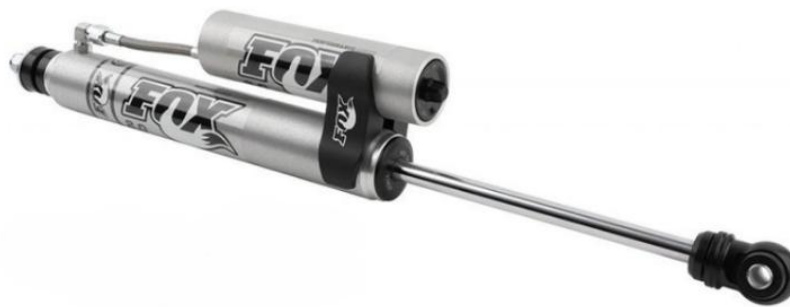
Рис. 1.10. Регульований амортизатор з виносним резервуаром [7]
