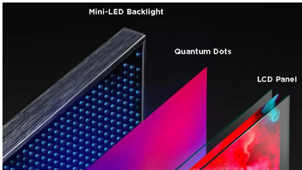
Рисунок 2.4 — Побудова Samsung Mini-Led дисплею [8]
