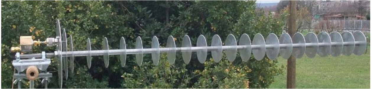
“Рис 2.1 — Приклад фізичного вигляду дискостержневої антени із лінійною поляризацією”
