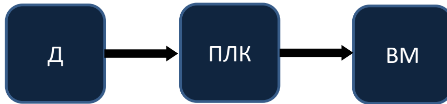
Рисунок 2.15 – Структурна схема надійності регулювання циркуляційним насосом
