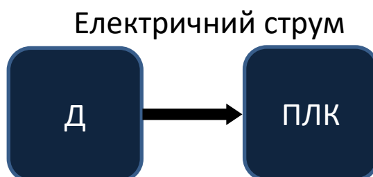
Рисунок 2.1 – Схема структури ВК ІВС для температури води в головному баку та баку для теплої підлоги
