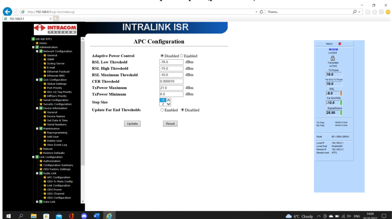
Рис. 3.17 Вкладка Radio Link / APC Config
