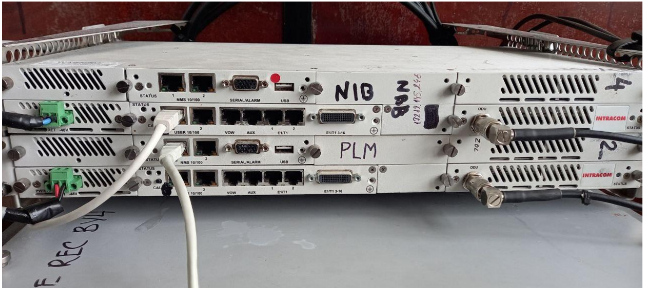
Рис. В.3 Модуль релейної лінії
