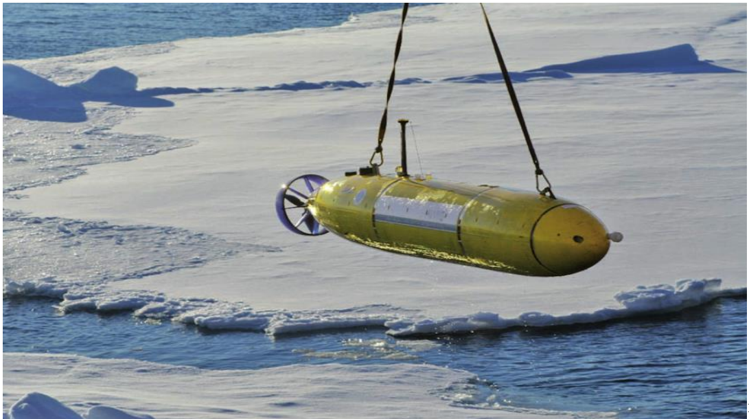
Рисунок 1.2 — Автономний підводний апарат Bluefin-21, що використовувався для пошуку втрачених повітряних суден
