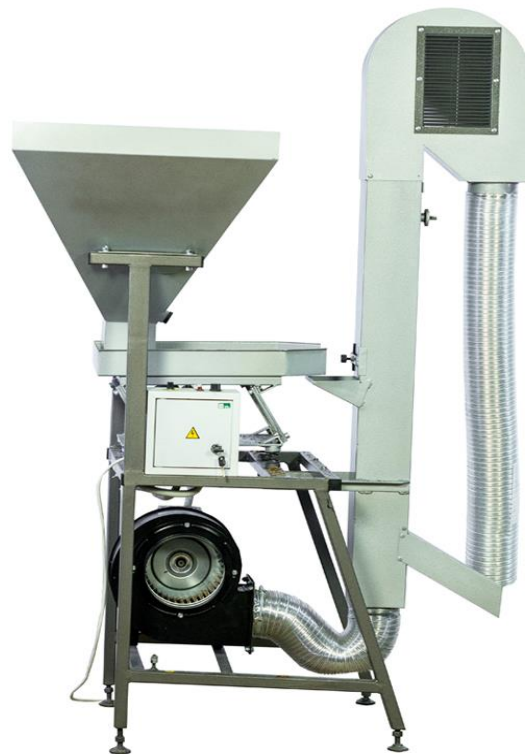
Рисунок 2.7 – Аспіраційна колона з віброподачею
