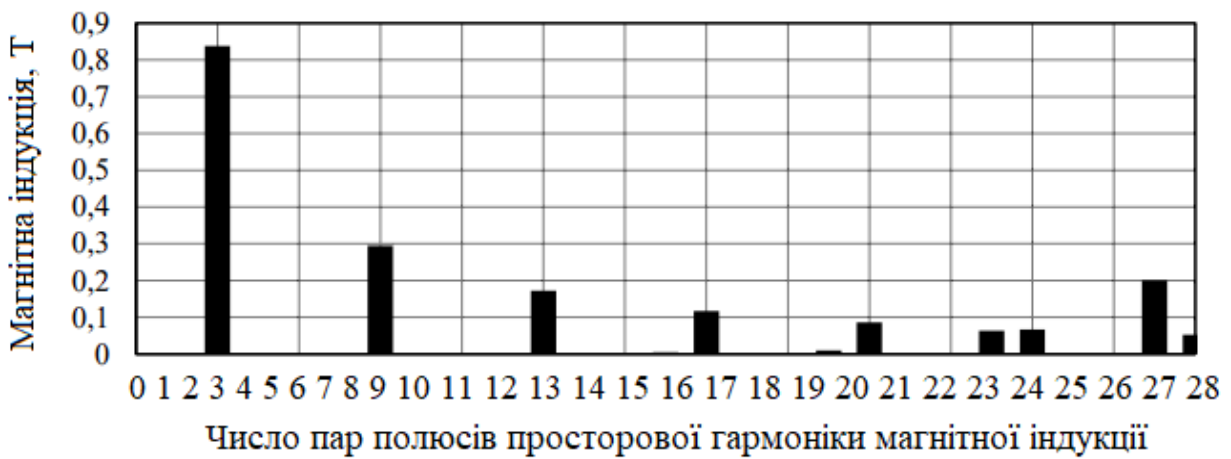
Рисунок 2.27 – Радіальна складова вектора магнітної індукції у внутрішньому немагнітному зазорі за відсутності в магнітній системі ПМ статора:
