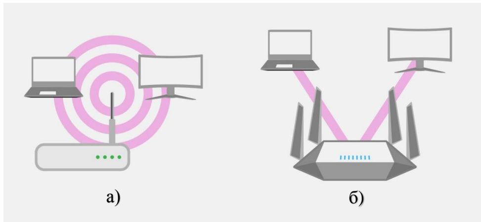
Рисунок 1.5 – Приклад принципу формування (направлення) променів
