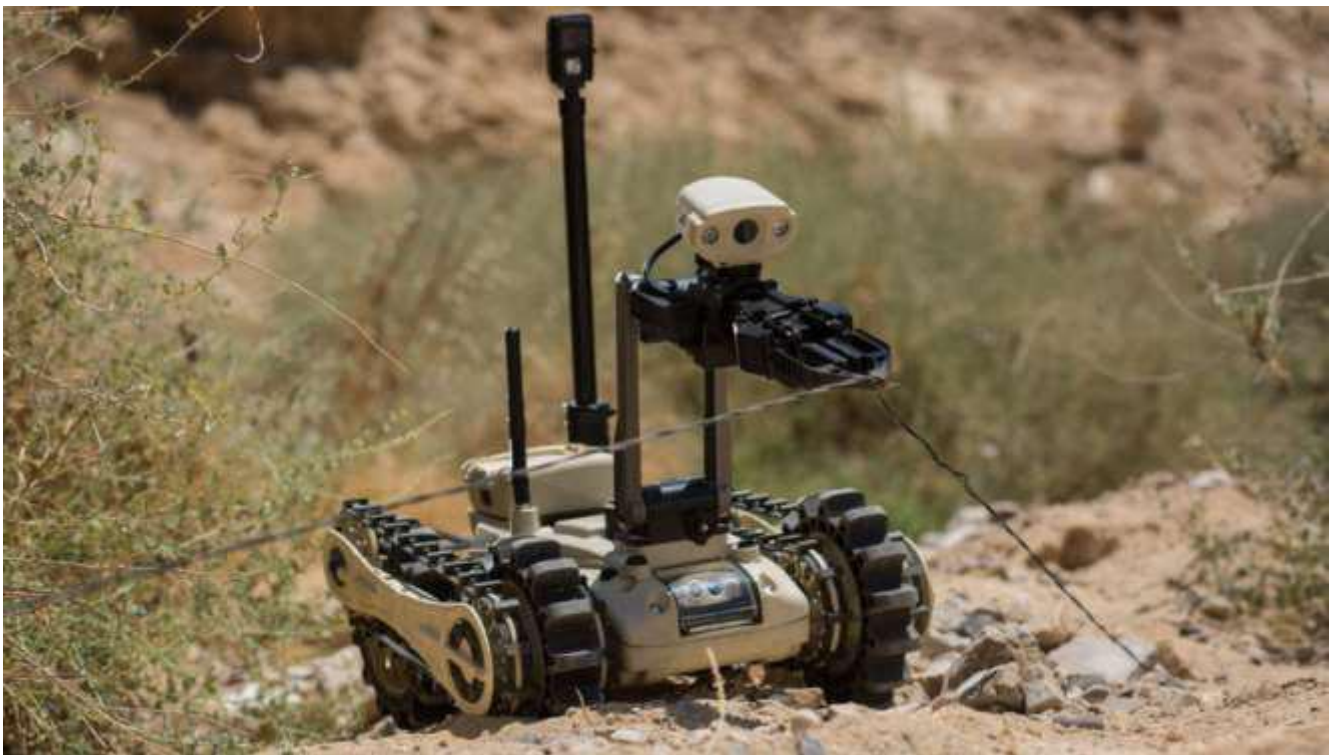
Рис. 2.2 Гусеничний робот виконує роботу по знешкодженню міни
