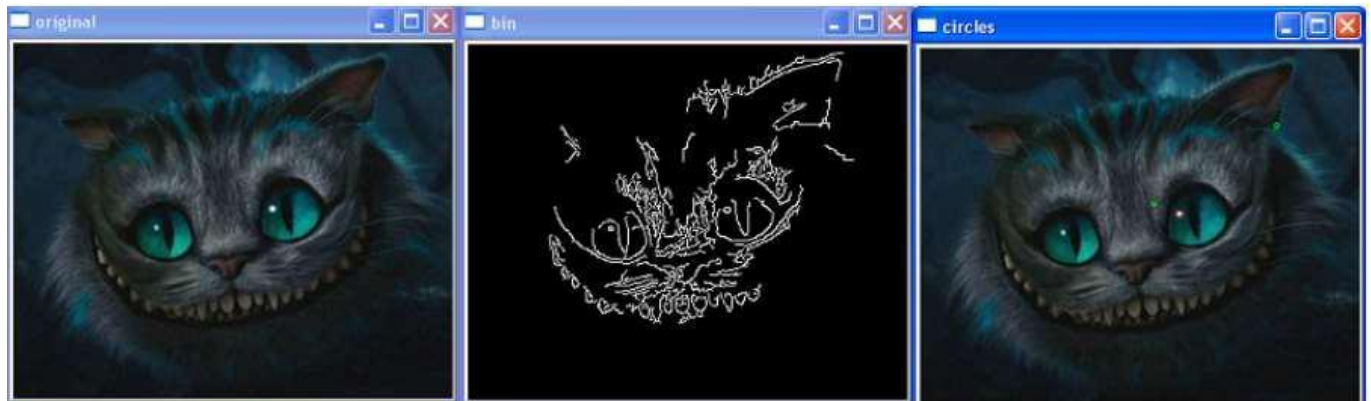
Рис.2.13 Приклад використання контурного аналізу при обробці зображень
