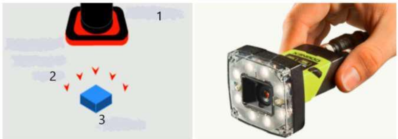
Рис. 2.3 Інтегроване джерело світла с дифузним кільцем(1 - об'єктив; 2 - кільцеве джерело світла; 3 - об'єкт)
