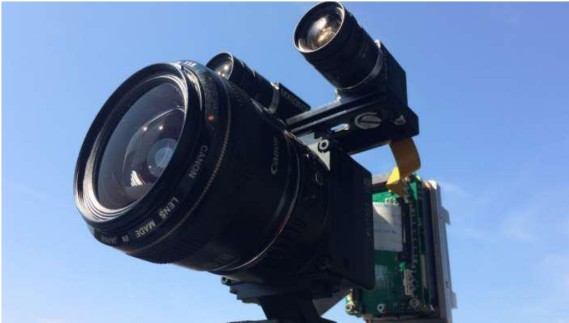
Рис.2.10 Багатокамерна відео-система для устаткування на бортах БПЛА
