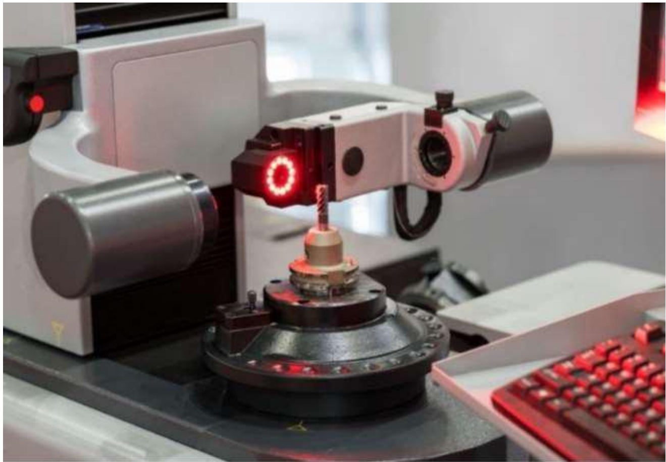
Рис.2.21 Контроль якості виготовлення деталей за допомогою комп'ютерного зору
