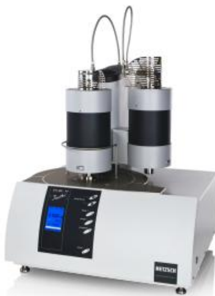
Рис. 2.6. Прилад для дослідження термостабільності структури методом ДСК
