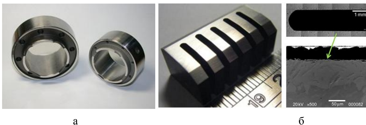
Рис. 1.5. Фотографії виробів з ВЕСів, що застосовуються в промисловості а) підшипник виготовлений зі сплаву \text{Co}_{1,5}\text{CrFeNi}_{1,5}\text{Ti}_{0,5} ; б) фільтр з ВЕСу \text{Al}_{0,3}\text{CrFe}_{1,5}\text{MnNi}_{0,5} із зміцненим поверхневим шаром [90, 91]
