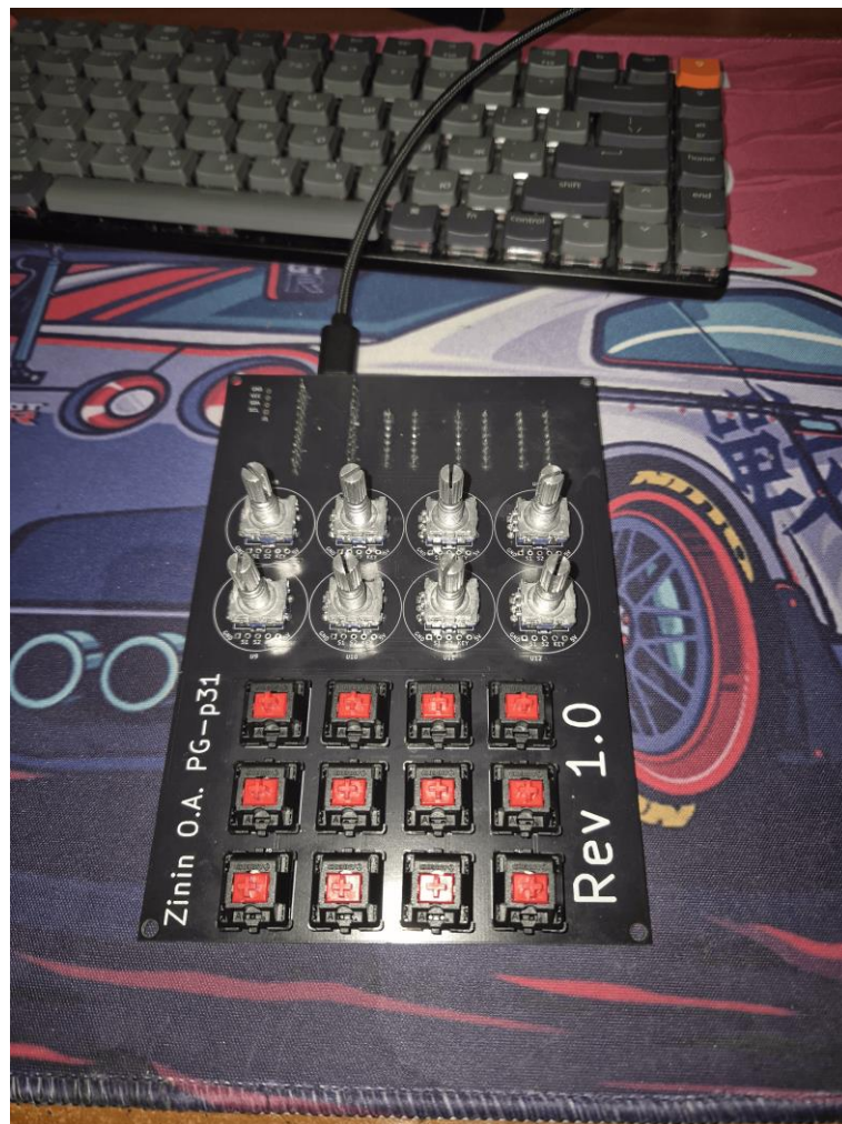
Рисунок 2.16 – Друкована плата з повністю змонтованими компонентами
