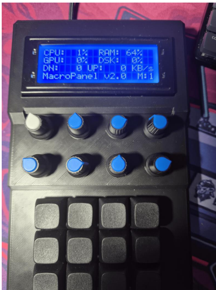
Рисунок 2.23 – Відображення навантаження системи на дисплеї пристрою
