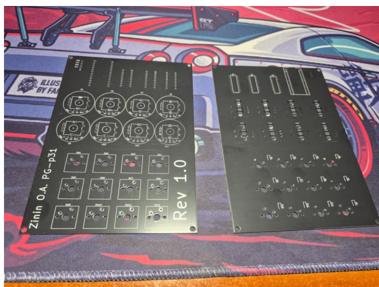
Рисунок 2.12 – Виготовлена друкована плата до монтажу компонентів
