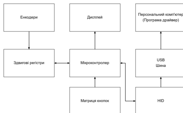
Рисунок 2.1 – Структурна схема пристрою
