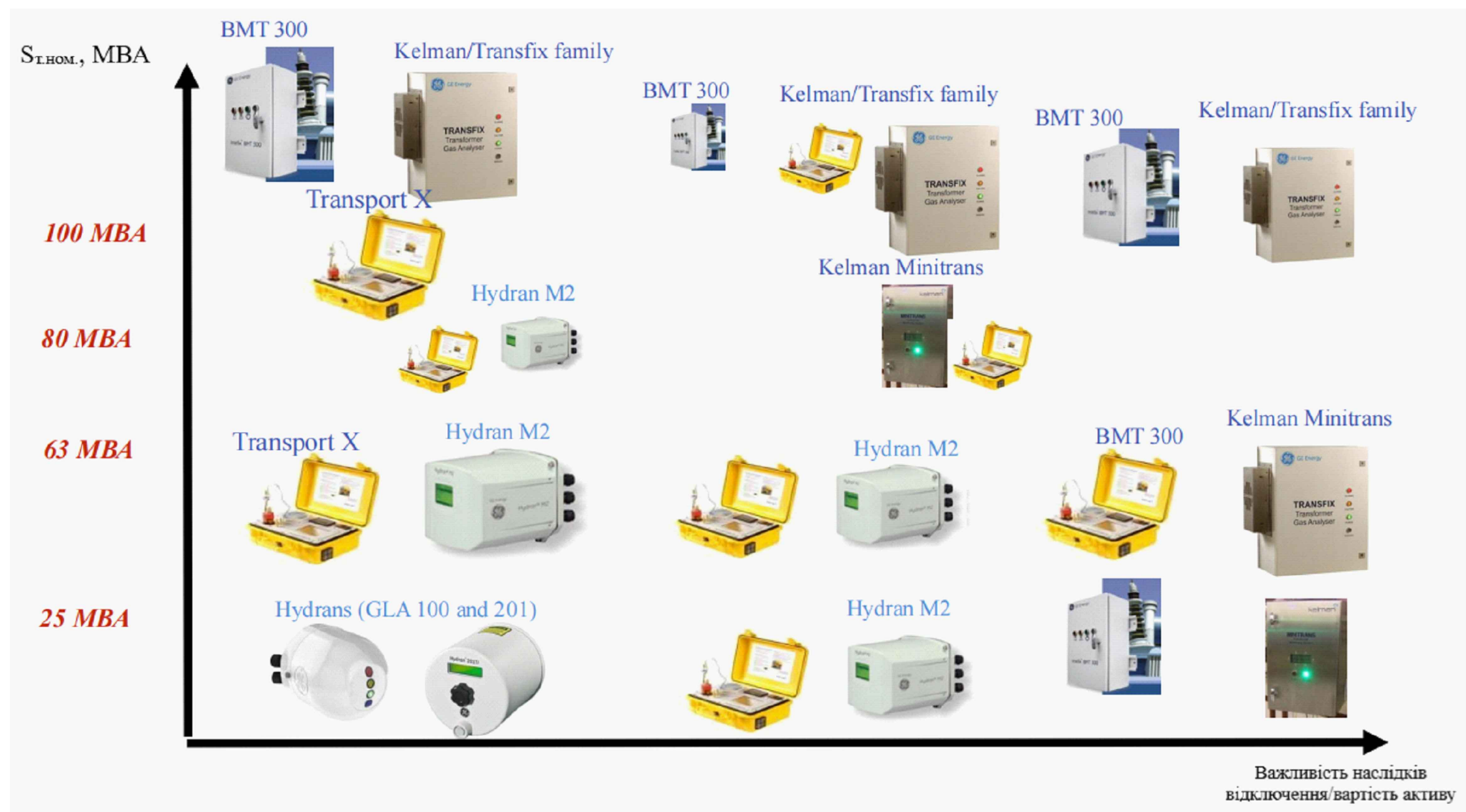
Вибір датчиків в залежності від потужності трансформатора та відповідальності споживача
