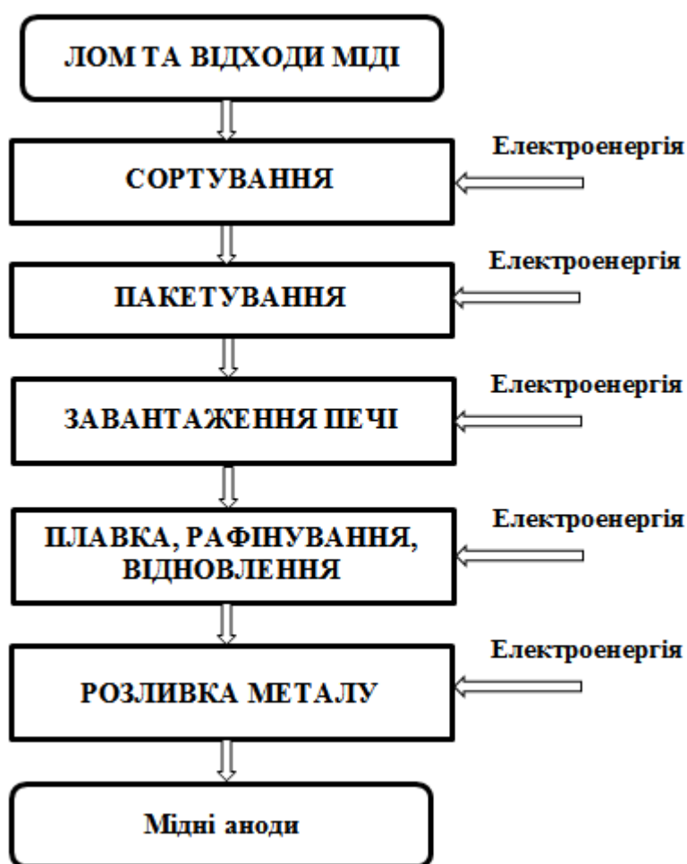
Рис. 4.2. Технологічна схема процесу виробництва мідних анодів
