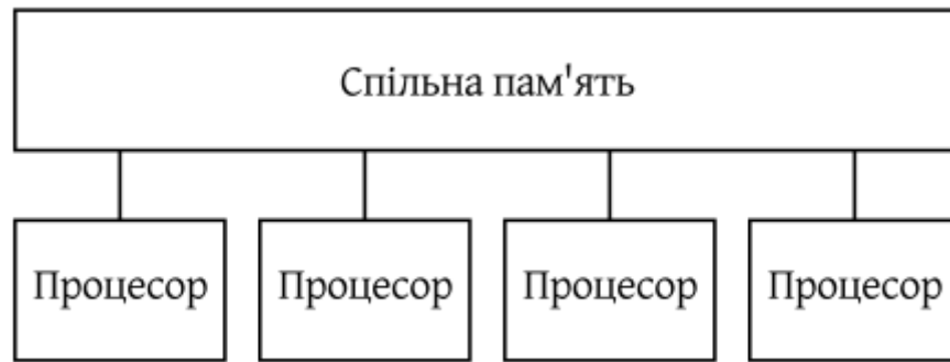
Рис. 1. Спрощена структурна схема ПОС зі спільною пам'яттю UMA
