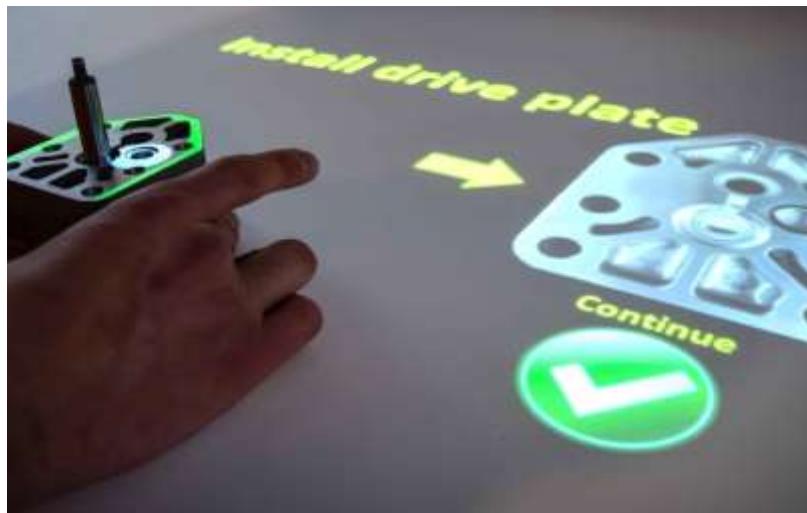
Рис. 1.7 Розширення реальності за допомогою проекції інформації на поверхню[12]
