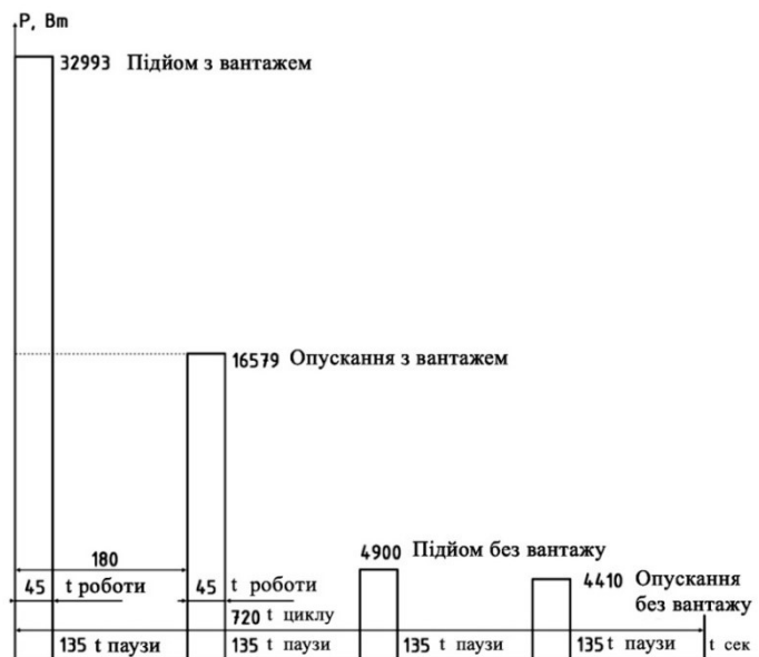
Рисунок 2.2 – Навантажувальна діаграма підйомного механізму
