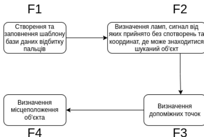
Рис. 2.3 Загальний алгоритм визначення місцеположення об'єкта в умовах завад
