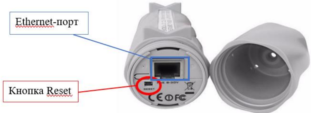
Рис. 3.2 Розташування Ethernet-порту та кнопки скидання налаштувань (Reset) на пристрої MikroTik Groove A-52HPn
