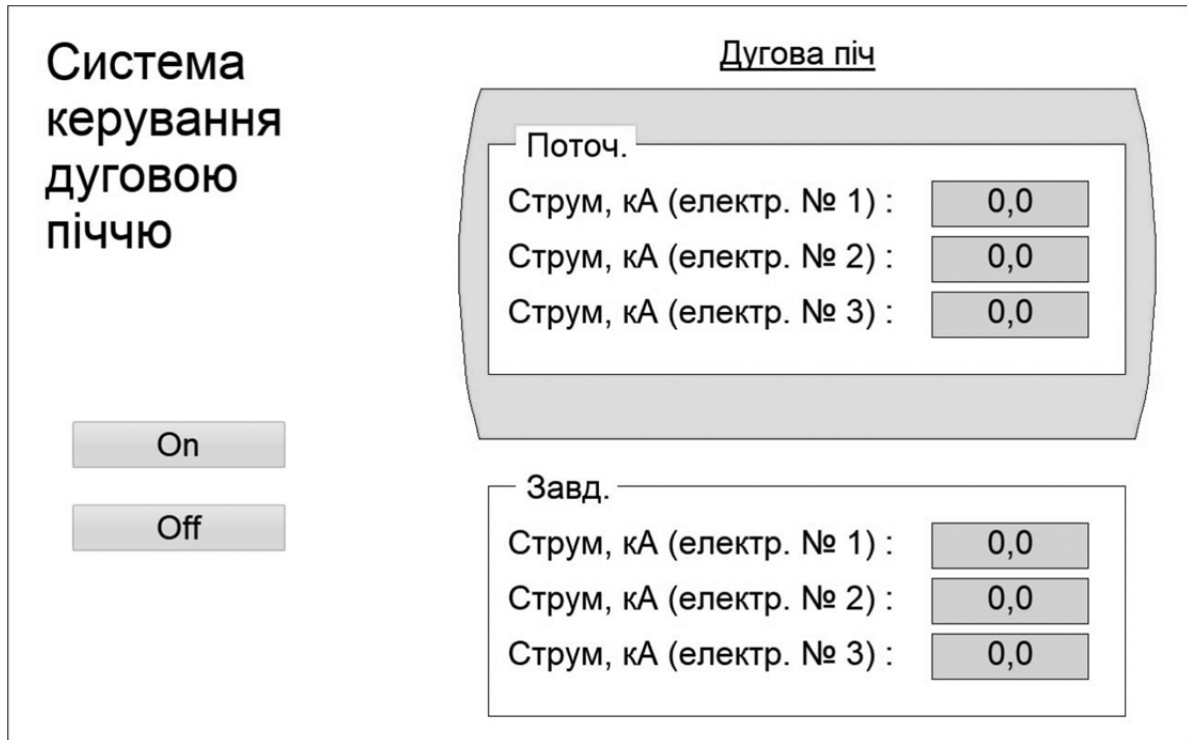
Рис. 9.10. Мнемосхема SCADA-системи для системи керування дуговою піччю
