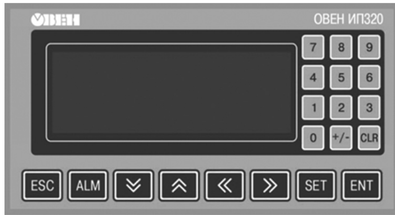
Рис. 7.2. Зовнішній вигляд передньої панелі ИП320
