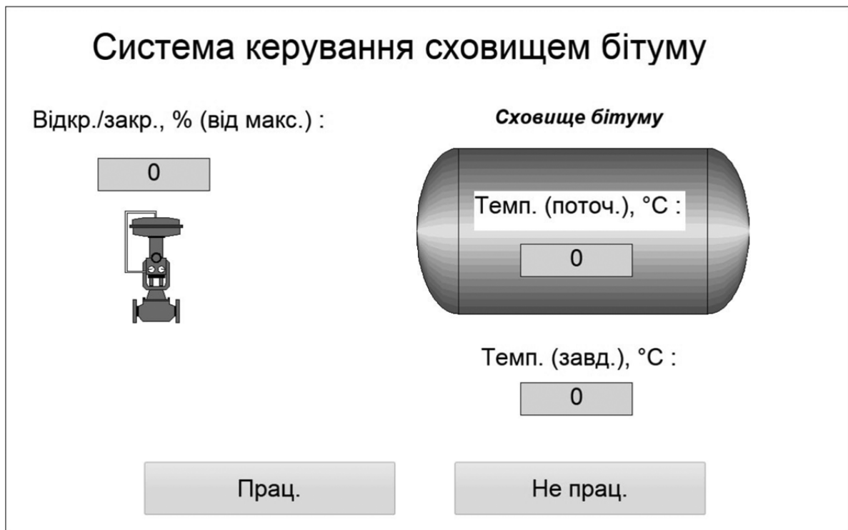
Рис. 9.8. Мнемосхема SCADA-системи для системи керування сховищем бітуму
