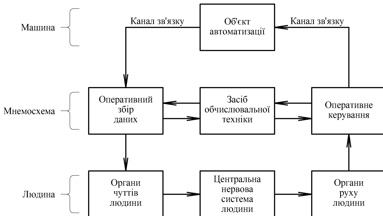
Рис. 1.1. Спрощена схема людино-машинного інтерфейсу
