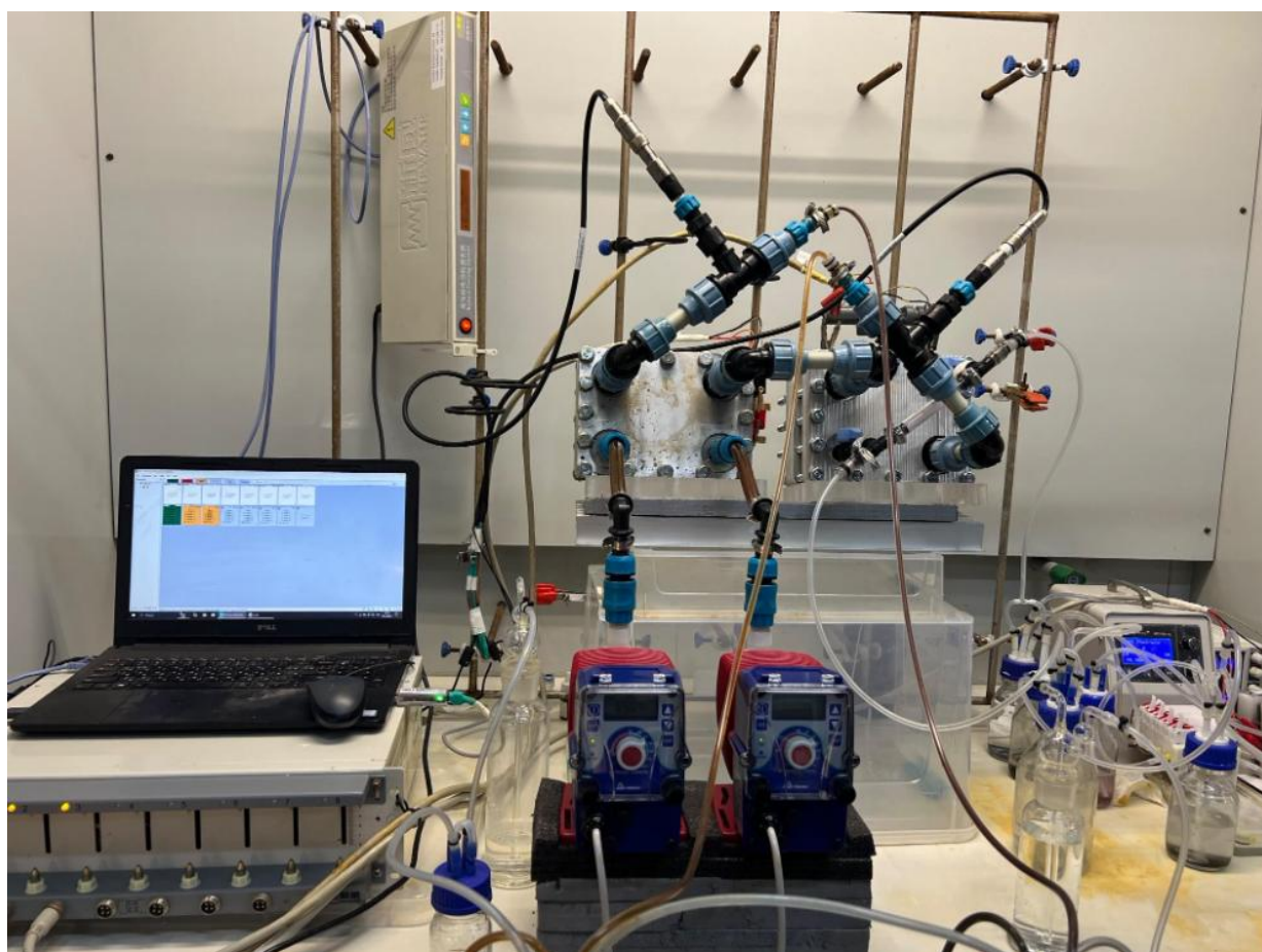
Рисунок 2.2 – Тестувальний стенд для дослідження стеку AIFB та регенераційної комірки
