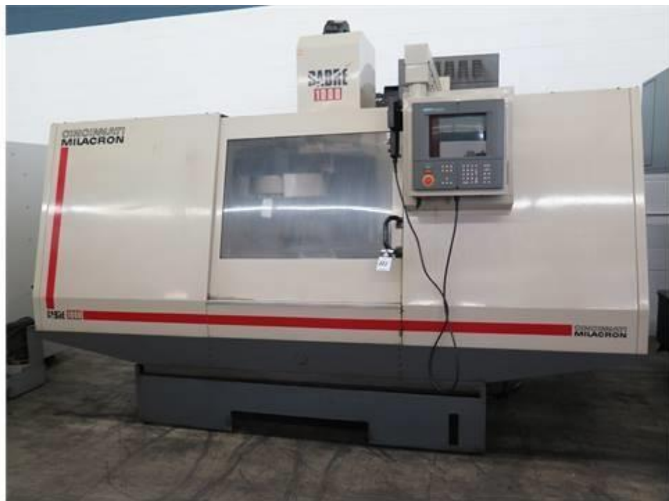
Рис.2.3. Універсальний вертикальний фрезерний верстат 1х Cincinnatti Sabre 1000
