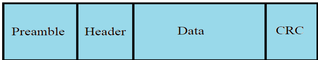
Рисунок 3.3.1 – Структура пакету від кінцевого пристрою до шлюзу
