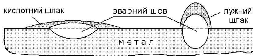
Рис. 7.14. Особливості форми зварних швів, виконаних під флюсами різних типів
