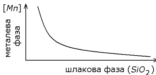
Рис. 7.17. Залежність вмісту марганцю в металевій фазі від кількості оксиду кремнію в шлаковій фазі (схематично)
