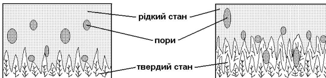
Рис. 10.2. Утворення пор на фронті кристалізації металу (схематично)
