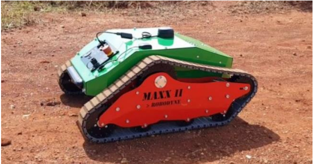
Рисунок 1.2 – Наземний роботизований комплекс з пасивно деформованим профілем гусениці [9]
