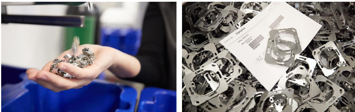
Рис. 3.4 – Елементи розетки які виготовляють за допомогою листового штампування
