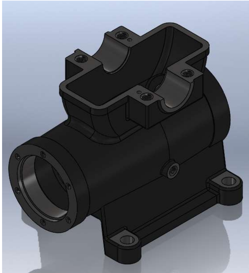
Рисунок 2.2 – 3Д модель деталі «Корпус черв'ячного редуктора»
