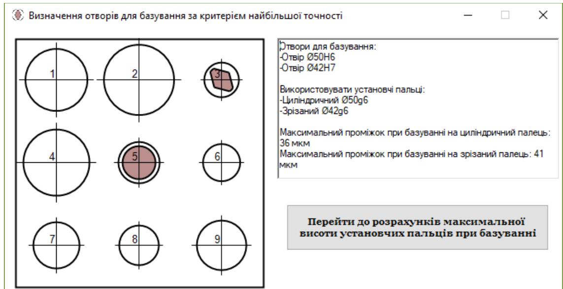
Рис. 1.9. Вікно «Визначення отворів для базування за критерієм найбільшої точності»
