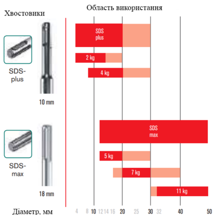
Рисунок 1.1.2 Форми хвостовика SDS – max та SDS – plus[1]
