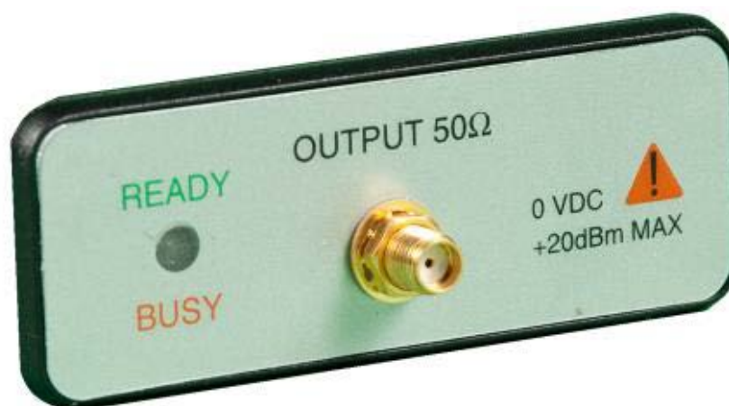
Рис. 3.7. Передня панель генератора частот та радіочастотний вхід SMA 50 Ом
