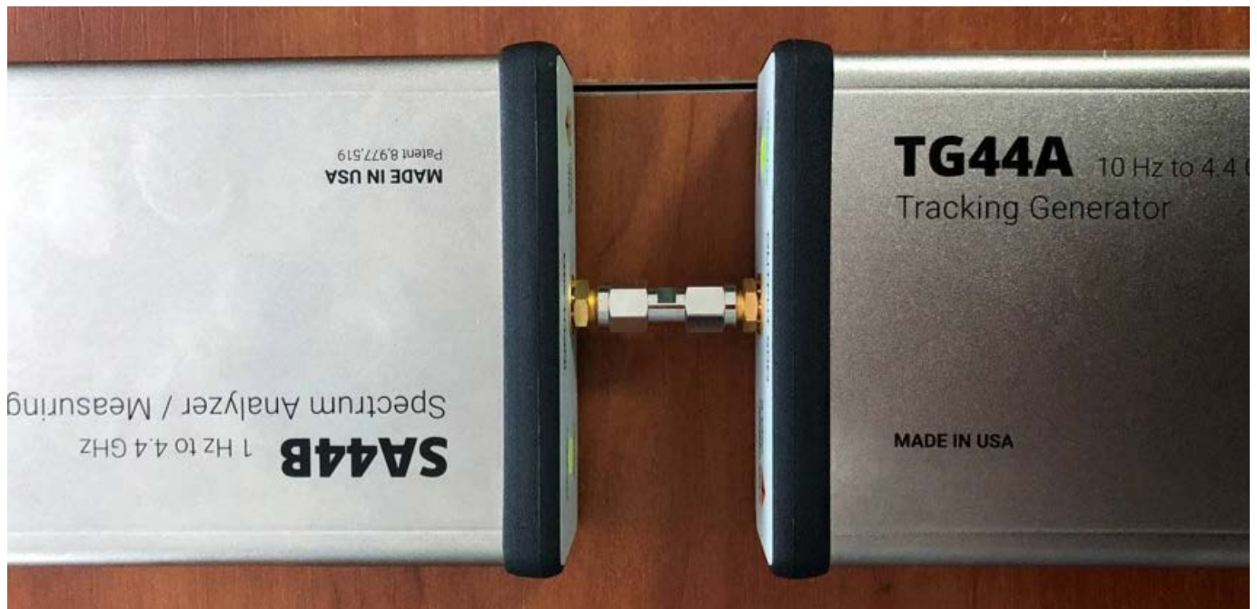
Рис. 3.14. Схема підключення пристроїв до ПК на реальному прикладі в режимі калібровки. а) Загальний вид. б) Детальний вид.
