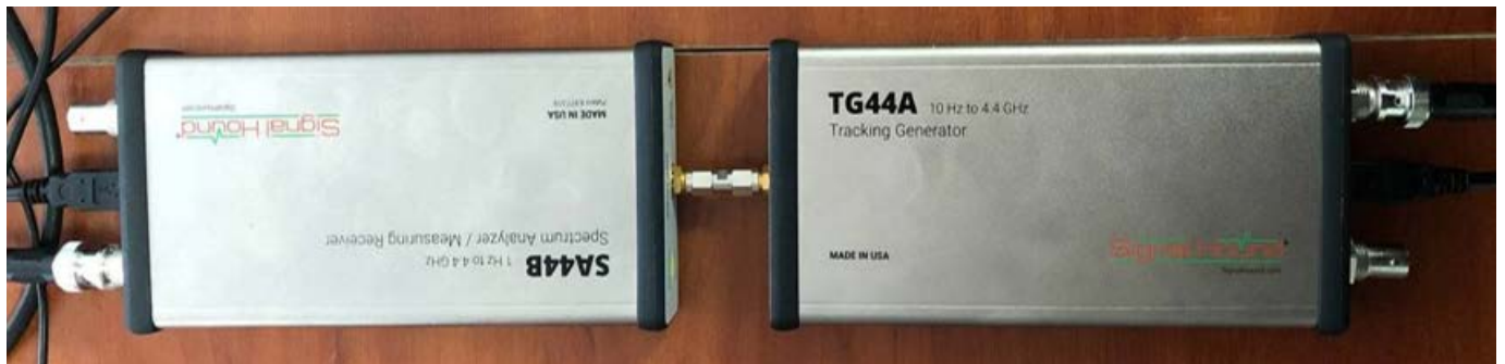
Рис. 3.13. Схема підключення аналізатора спектра + генератора до ПК
