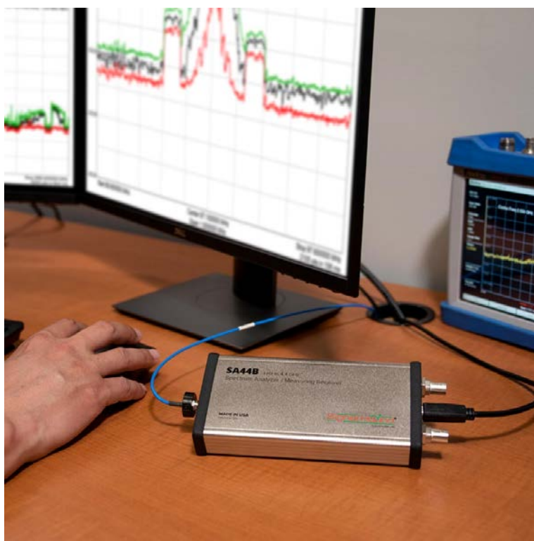
Рис. 3.3. Signal Hound USB-SA44B. а) Аналізатор спектру. б) З'єднання з ПК
