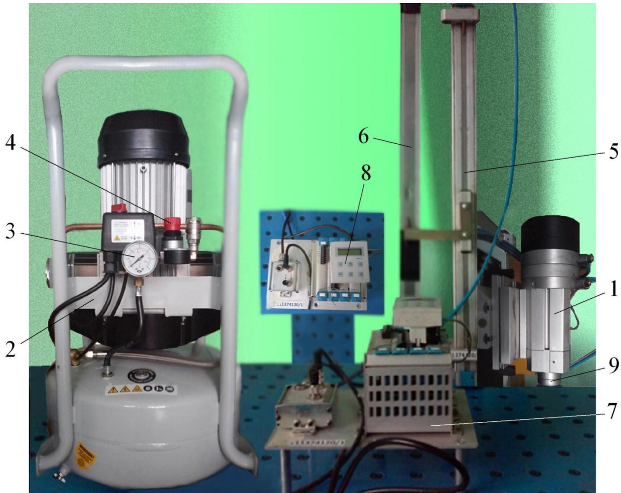
Рис. 6.2. Експериментальний стенд генератора тяги
