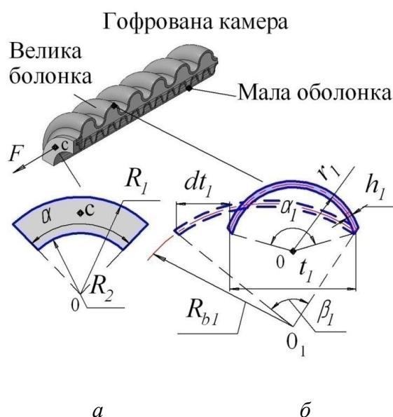
Рис. 4.34. Розрахункова схема гофрованої оболонки: а – схема заглишки; б – схема оболонки
