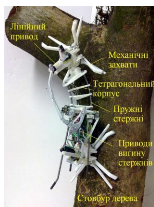
Рис. 1.9. Мобільний робот [11] для обслуговування деревних масивів ( a ) та залежність між кутом вигину хребта робота ( б ), силою зчеплення та зусиллями зсуву [38]
