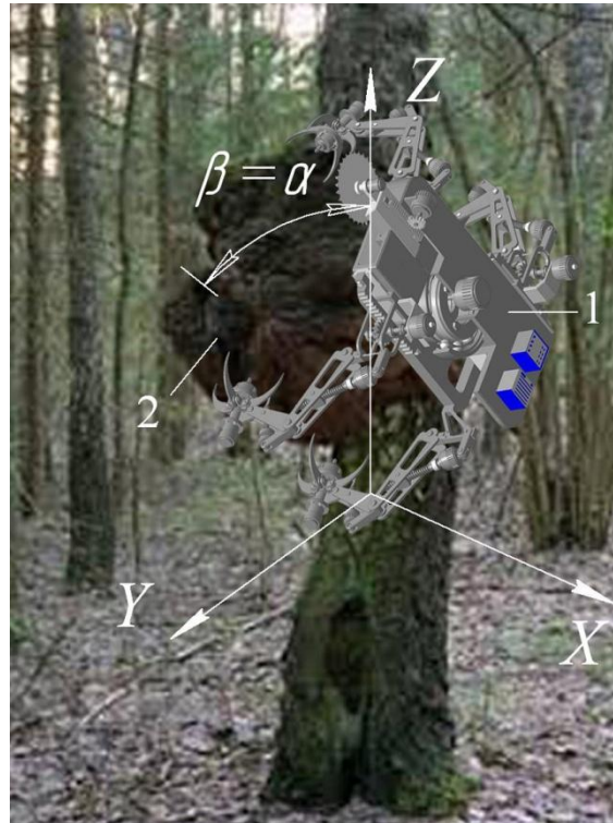
Рис. В-2. Положення мобільного робота під час обрізування наросту:
