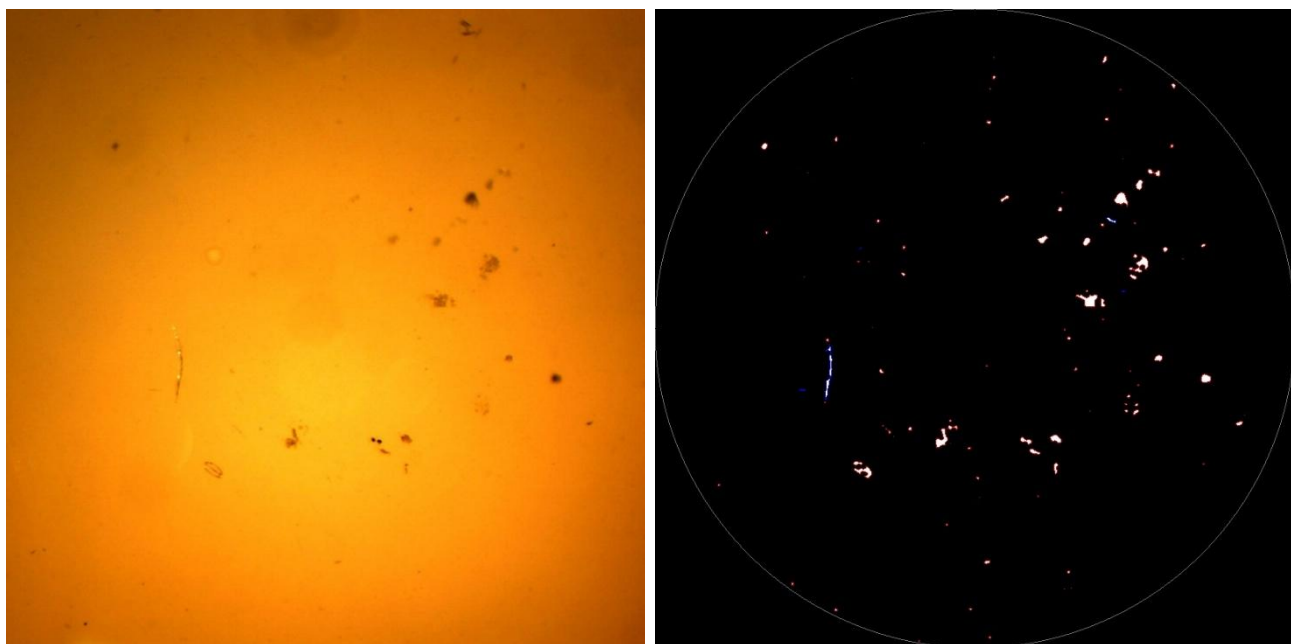
Рис. 3.18 Зображення 1 до обробки(зліва), зображення 1 після обробки з наведеними контурами дефектів (справа)
