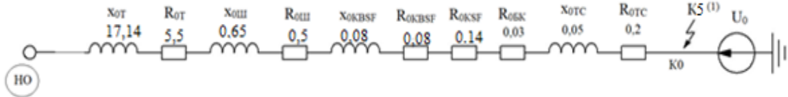
Рисунок 2.15 – Схема заміщення нульової послідовності
