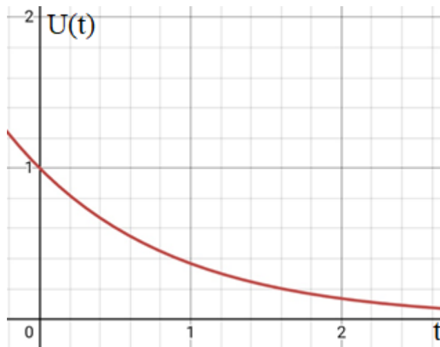
Рисунок 1.5 – Реакція RC-фільтра на одиничний імпульс
