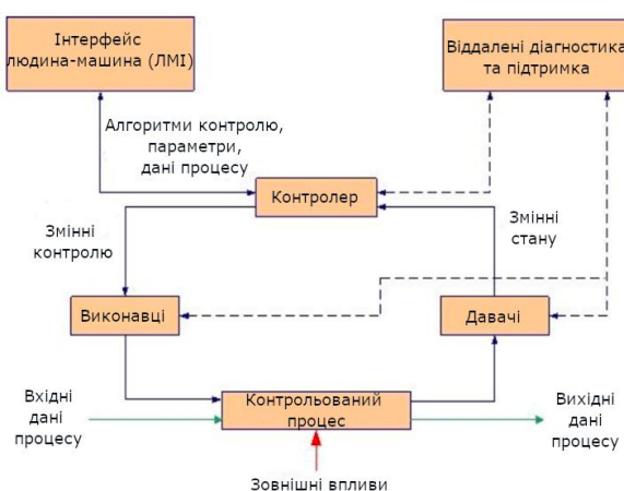
Рисунок 7.1 – Програмна схема функціонування АСУ ТП
