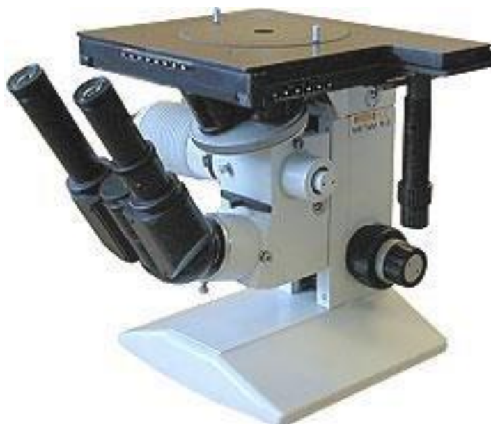
Рисунок 2.4 – Металографічний мікроскоп МЕТАМ з верхнім розташуванням предметного столику [42]
