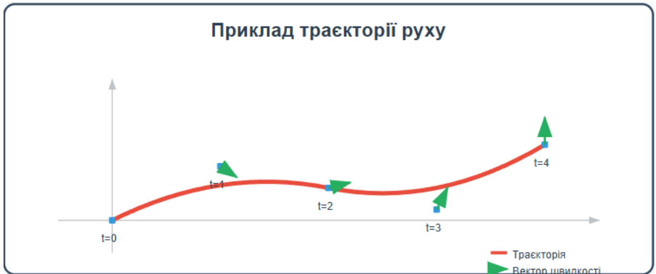
Рис. 3.3. Приклад планованої траєкторії руху робота-доставщика з векторами швидкості
