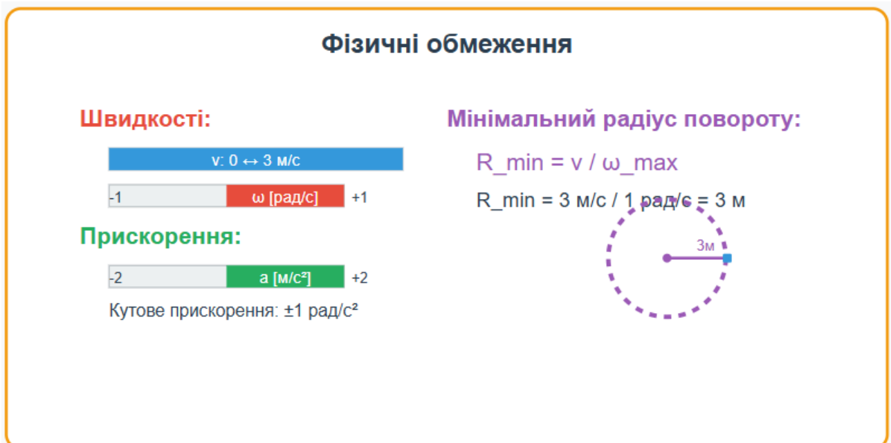
Рис. 3.2. Фізичні обмеження параметрів руху робота-доставщика
