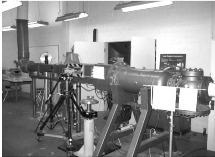
Рис. 1.21. Стенд для акустичних випробувань мікромеханічних гіроскопів
