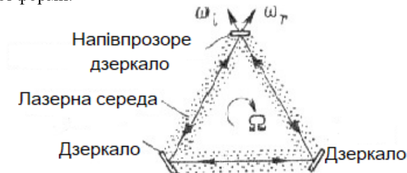
Рис. 3.77. Принципова схема кільцевого лазерного гіроскопа
