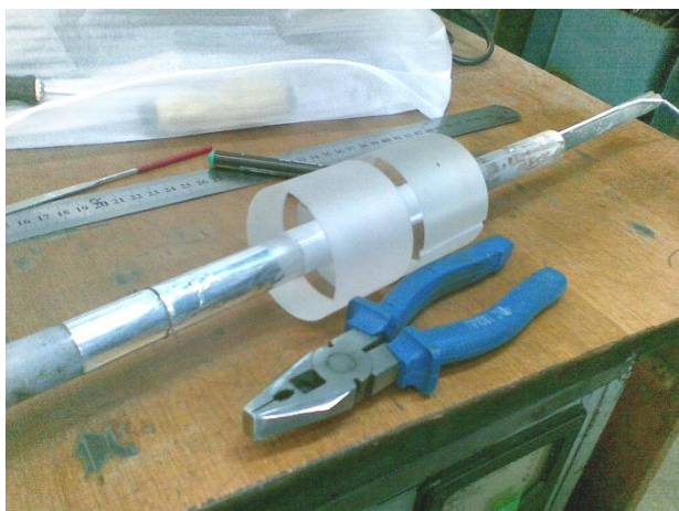
а б Рис. 2.18. Складання стандартного кварцового зразка
