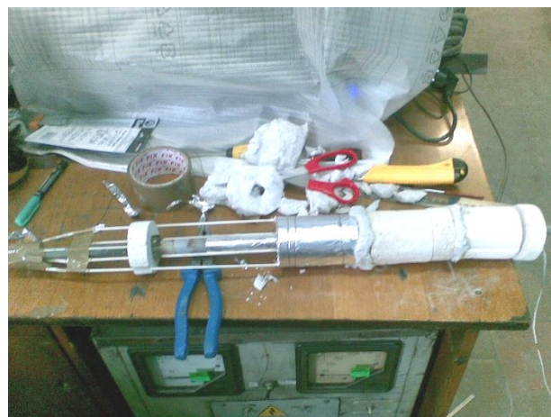
а б Рис. 2.18. Складання стандартного кварцового зразка
