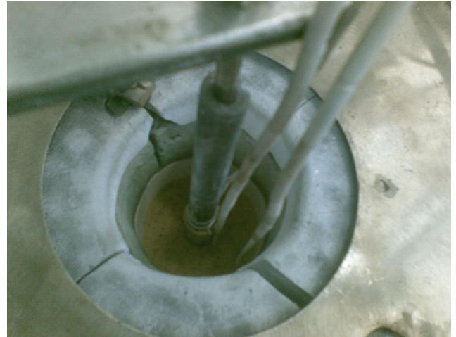
Рис. 2.8. Фотознімки змонтованих термопар ( a ) та вимірювальної комірки ( б )
