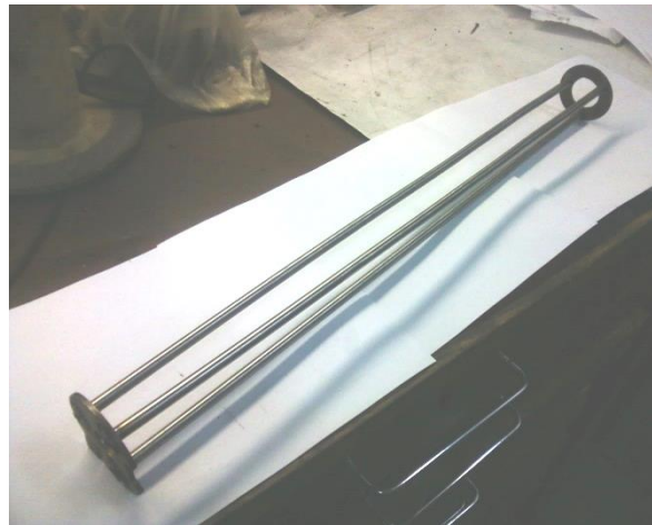
Рис. 2.9. Інструмент для трамбування досліджуваного сипучого матеріалу
