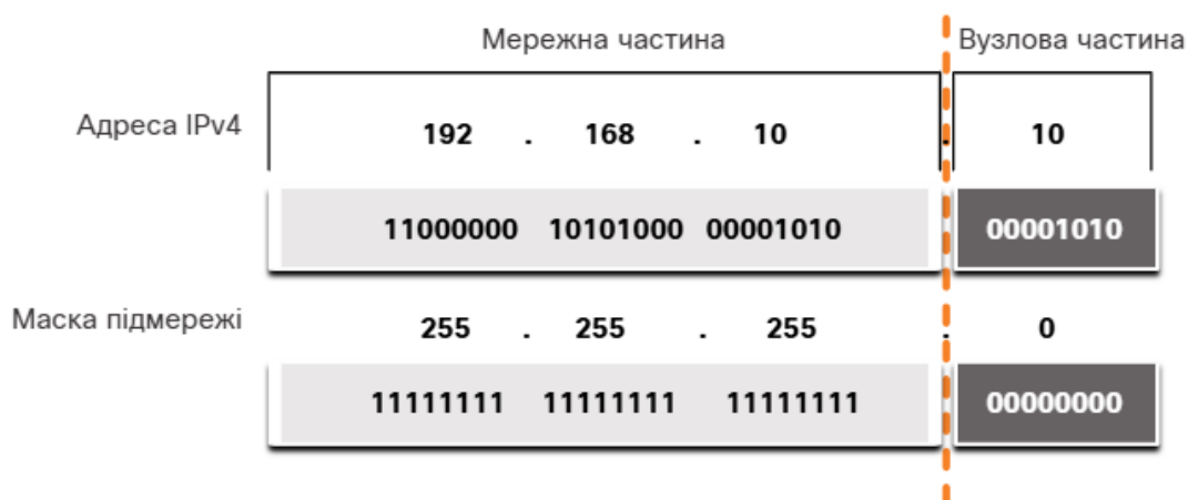
Рисунок 7.4 – Поєднання адреси IPv4 з маскою підмережі
