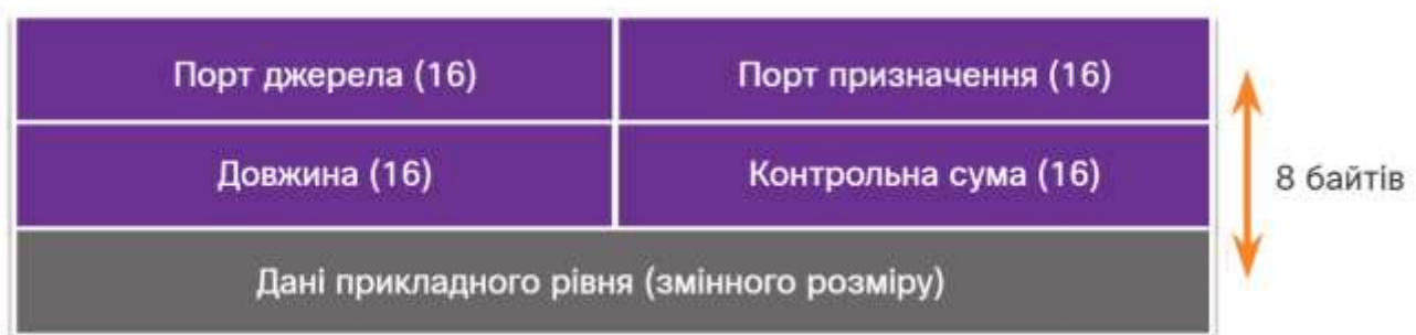
Рисунок 5.7 – Поля заголовку UDP
