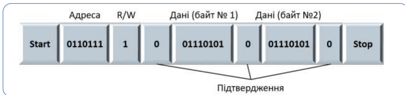
Рис. 5.6. Структура кадру та послідовність передачі даних по шині I2C
