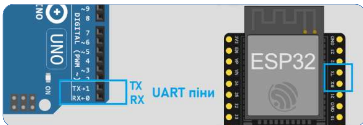
Рис. 5.1. UART-піни на платах розробника Arduino та ESP32
