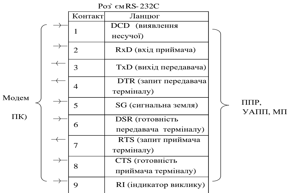
Рис. 9. 9-контактний роз'єм RS-232
