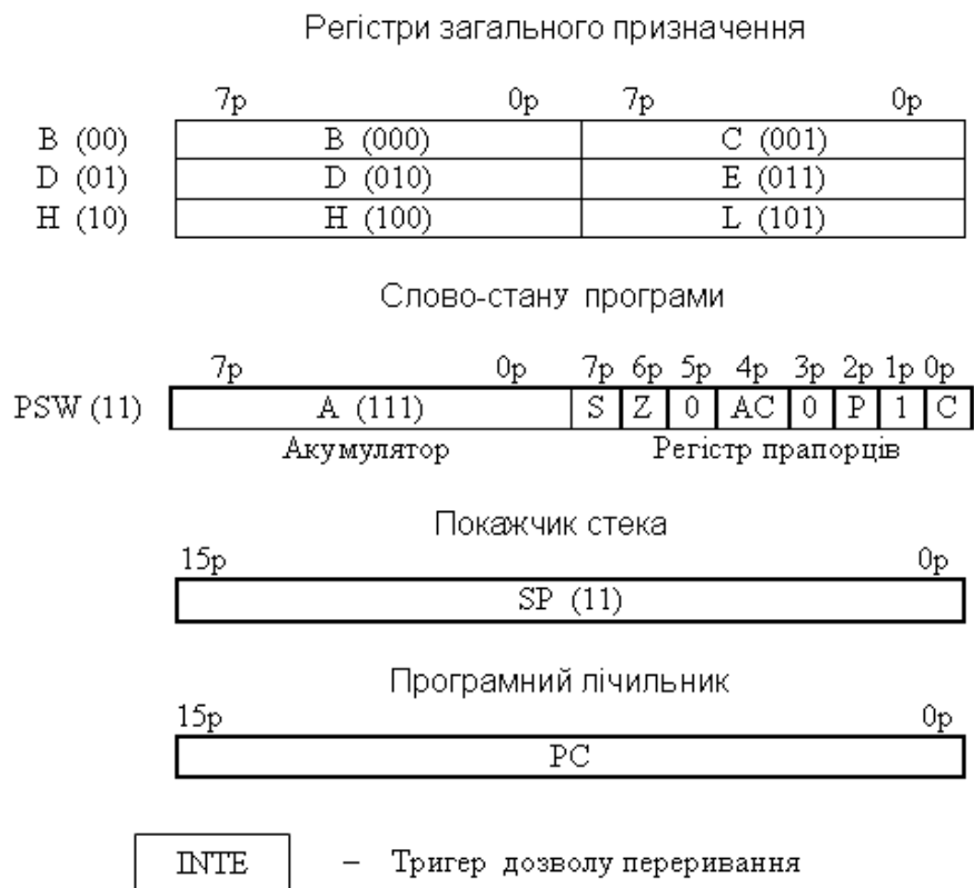
Рис. 1. Програмна (програмістська) модель МП i8080
